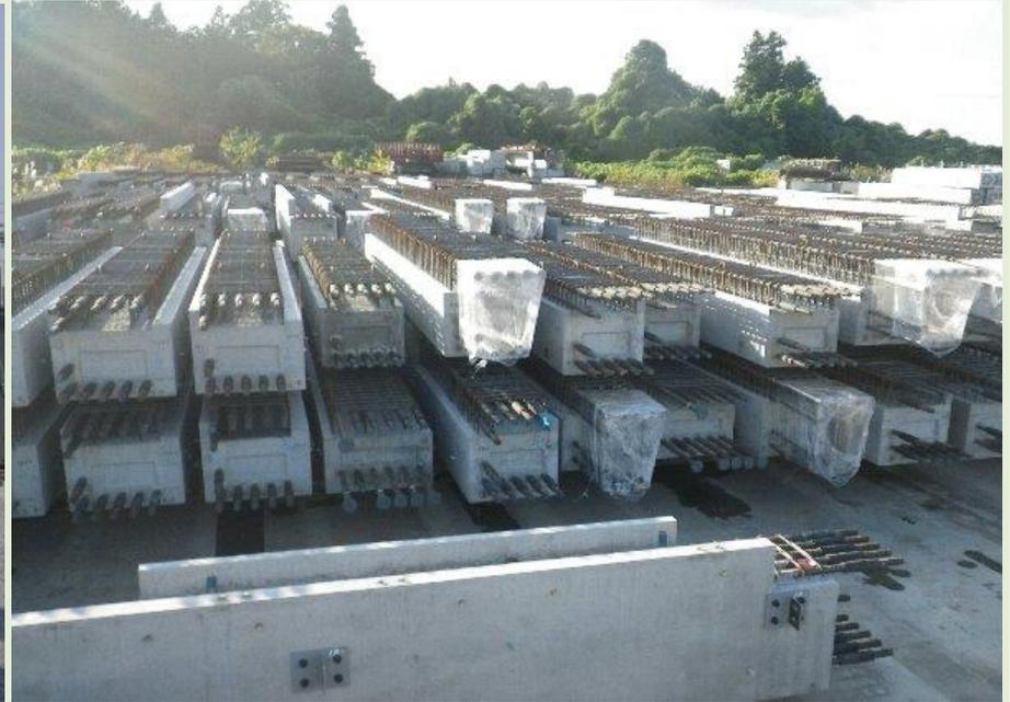
写真 4.4 梁部材の貯蔵方法の例
