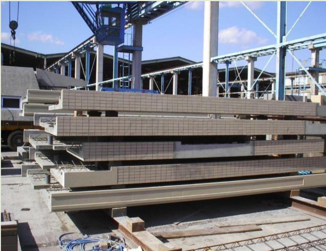
写真 4.2 平置き方法の例
