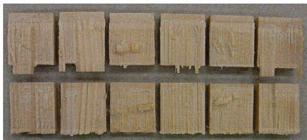
図 6.27 接着性能試験破壊性状（写真は上下一対で左から試験番号 1～6 の順番）
