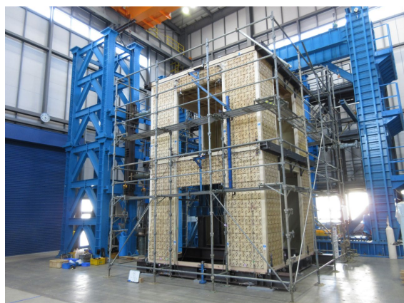
図 2.16 実大2層建築物水平加力実験（建材試験センター、2018）
