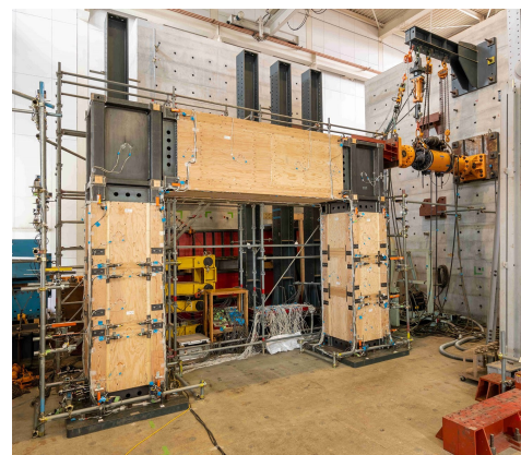
図 2.15 ラーメン架構の水平加力実験 (明治大学、2020) 10)
