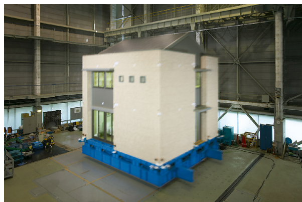
図 2.12 制震装置 MGEO 実大振動台実験 (大林組技術研究所、2004) 8)
