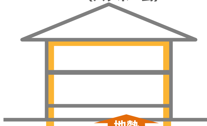
基礎内側に断熱材
