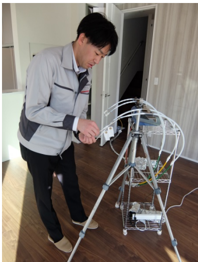
室内空気の捕集管設置
