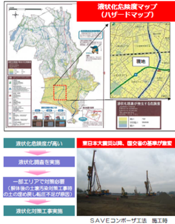
図-8 液状化対策工事 (セブコンポザ-工法)
