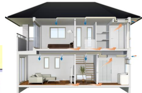
セントラル換気システム
