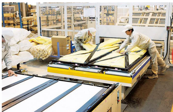
住宅：外壁パネルの生産
