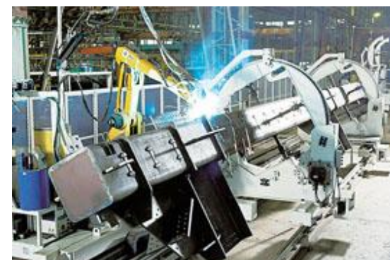
建築：鉄骨(柱)溶接
