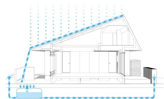
雨水集積・循環利用装置
