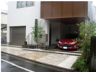
ビルトインガレージ上部をオーバーハングさせ、ファサードに立体感を与える
